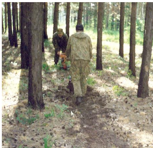
Рис. 1. Тяговый модуль с лебёдкой на базе бензопилы.
