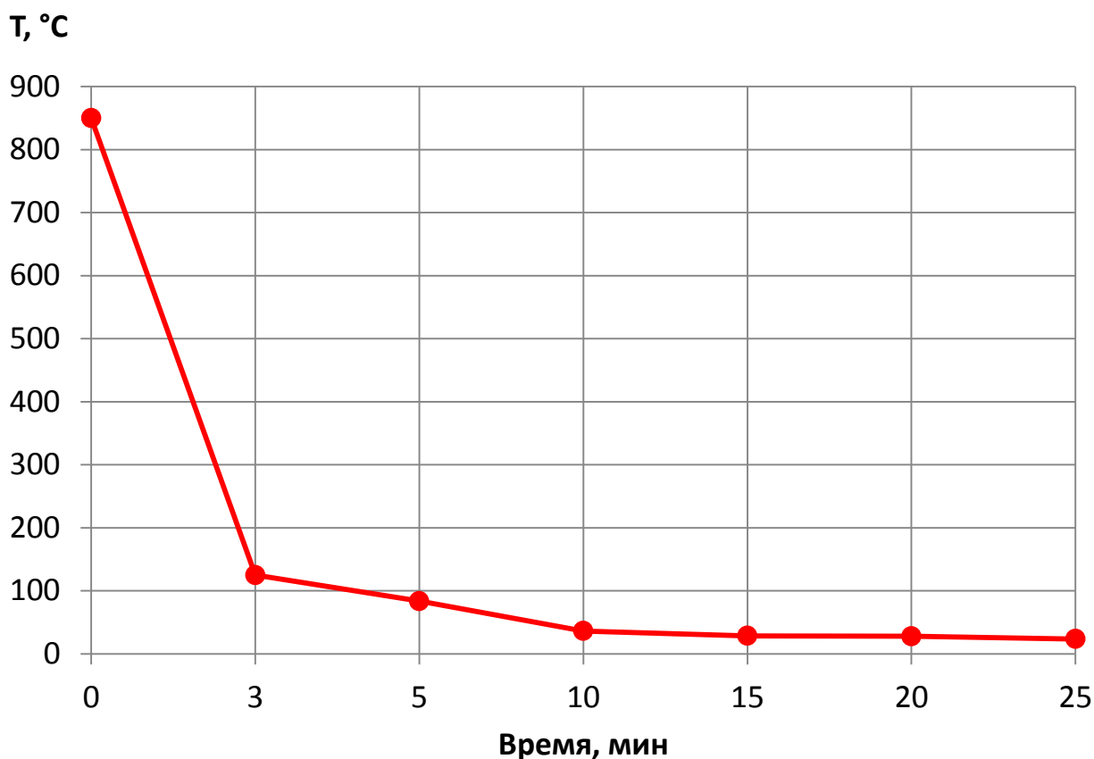
Рис. 3. Охлаждение образца из бронзы БрОФ7-0.2 на воздухе после ЭДТО
