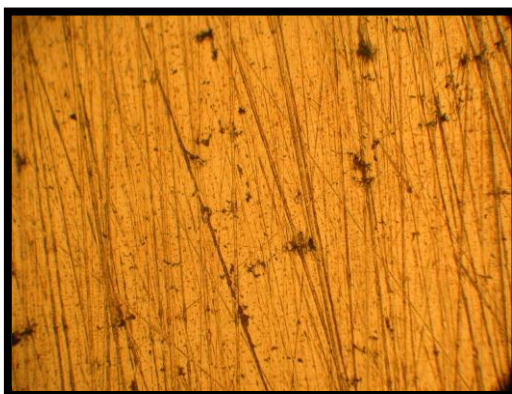
Микрофотография образца содержащий медь и 5,1 мас. (увеличено в 200 раз)
