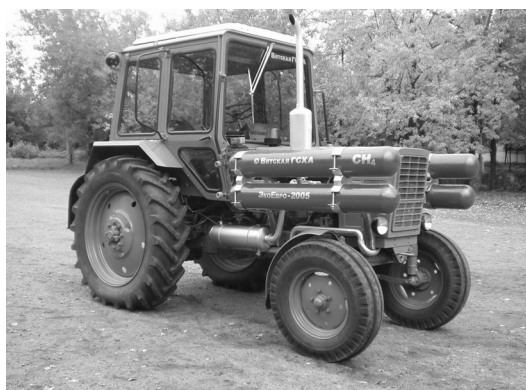
Рис. 2. Трактора МТЗ-80 с системой питания для работы на природном газе с РОГ
