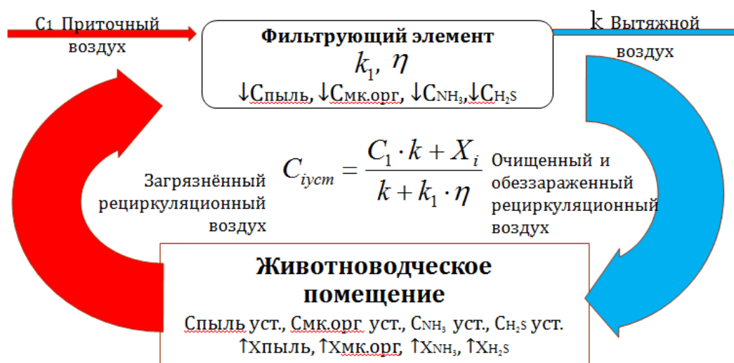
Рисунок 1 – Блок – схема рециркуляционной системы очистки и обеззараживания вентиляционного воздуха животноводческих помещений
