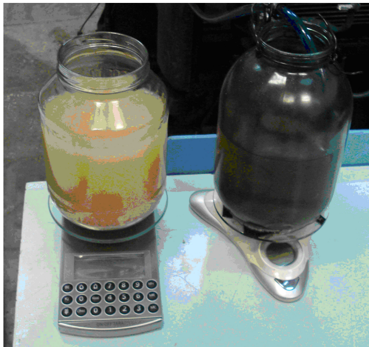
Рисунок 2. Водотопливная эмульсия (слева) и дизельное топливо (справа)
